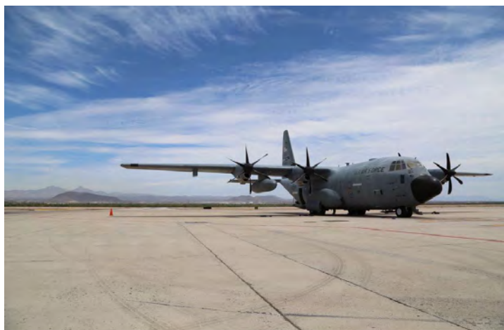
Figura 4. El Hércules WC-130 es un poderoso cazahuracanes. Tiene una longitud de casi 30 metros (similar a la de una cancha de basquetbol) y alcanza velocidades mayores a los 600 km por hora.
