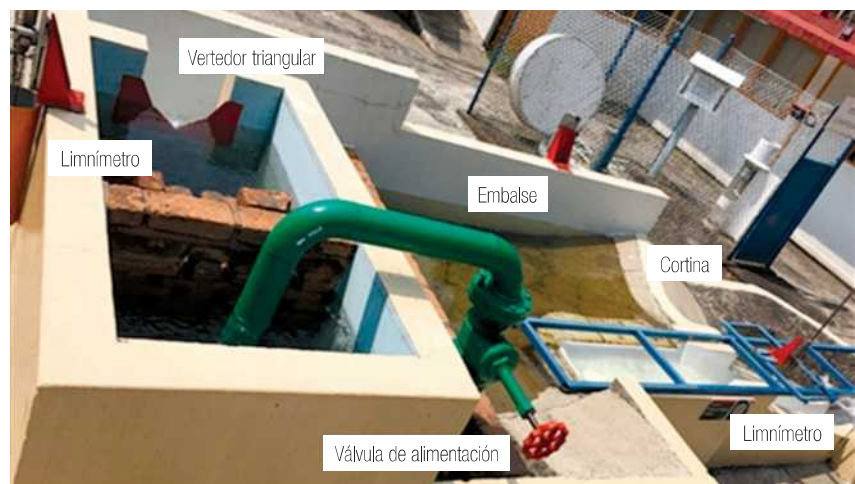
Figura 1. Modelo físico de la presa Tecate.
