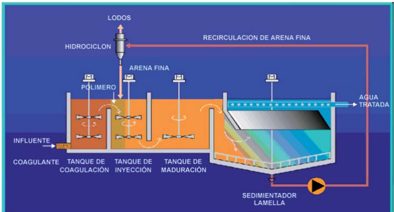
Figura 7. Proceso de floculación lastrada.
