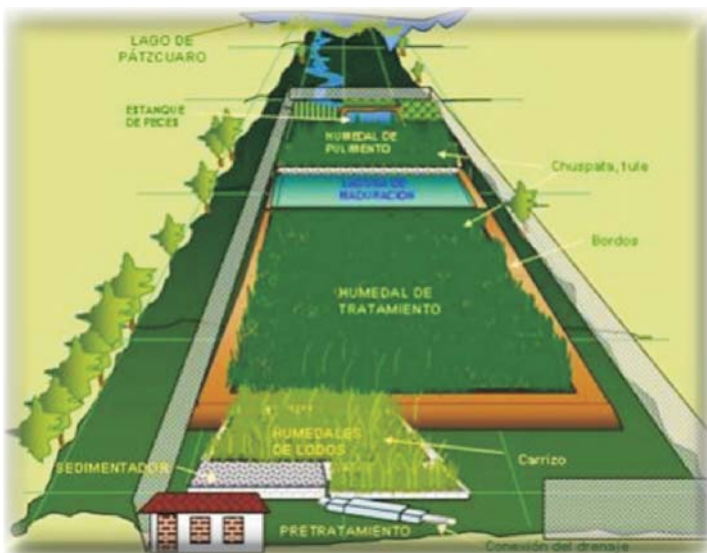
Elementos que constituyen un humedal de tratamiento.
