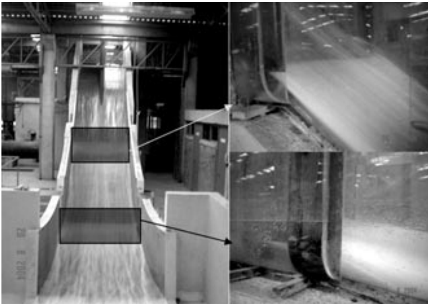
Fig. 3. Fotografía del modelo 1:21 del vertedor del P.H. Luis Donaldo Colosio, Huites, Sinaloa
