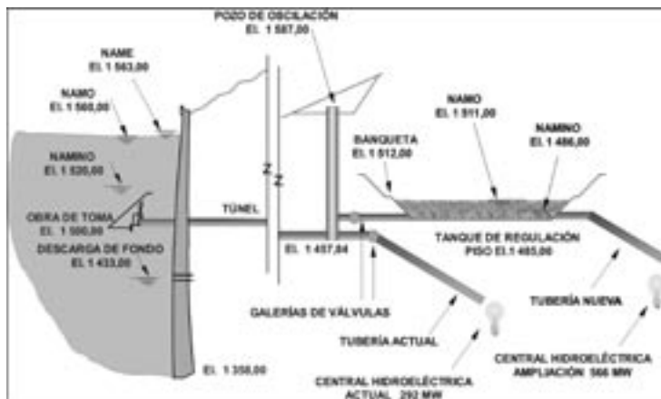
Tanque de generación. central hidroeléctrica Zimapán
