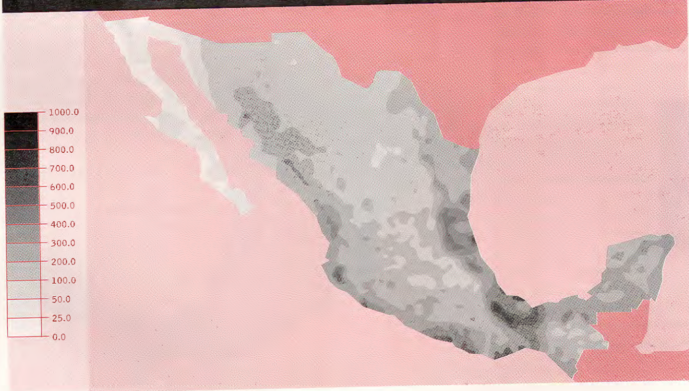
FIGURA 2 VALORES MÁXIMOS DE LA PRECIPITACIÓN ACUMULADA (MM) DURANTE 3 DÍAS EN LOS MESES DE MAYO A OCTUBRE, ASOCIADOS A UN PERIODO DE RETORNO DE 50 AÑOS.
