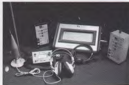
Detectores de Fugas Acústico y Electrónico
